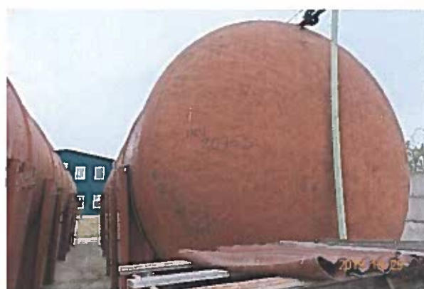
Rezervor suprateran din fibră de sticlă de 100 mc pentru depozitarea clorurii de calciu, nr. inv. 20765
