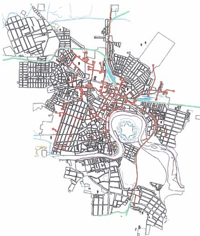
Figura 2.1 – Schema rețelei termice aparținând SACET Arad
