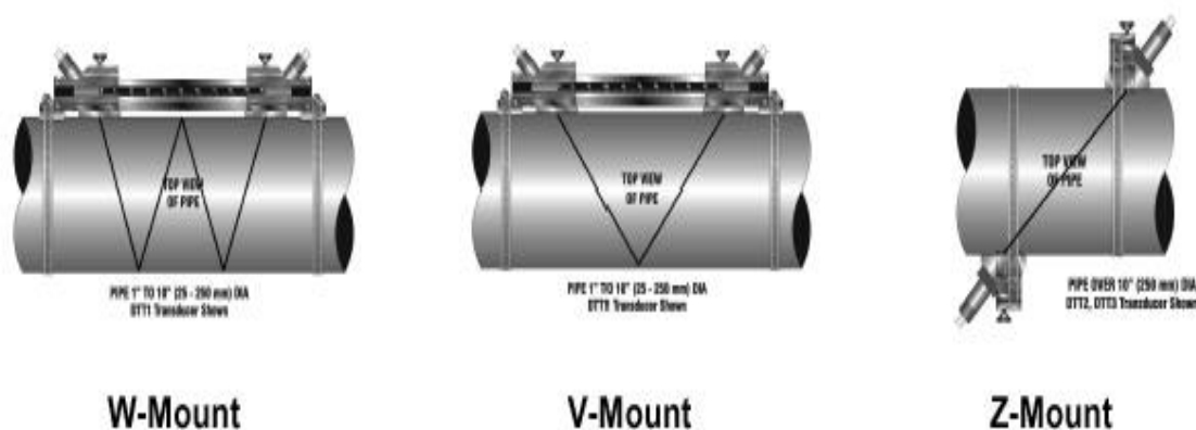
Figura 4.3. Scheme de montaj a traductoarelor
