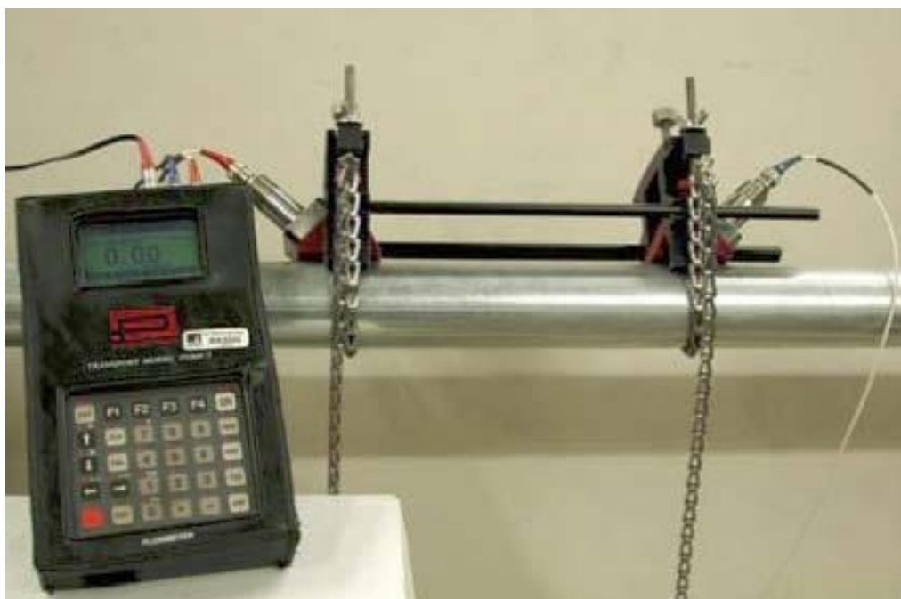
Figura 4.2. Traductoarele debitmetrului Panametrics PT 868
