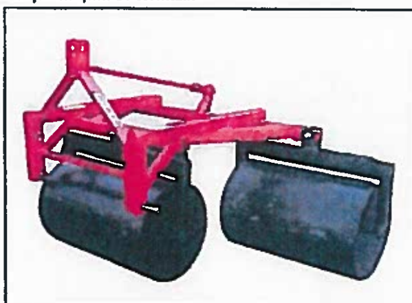
Fig.18 Imagine de prezentare a plasei de nisipare și a cilindrului compactor, ambele tractabile
